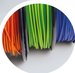
Thermoplastisches PU als 3D-Druckfilament
